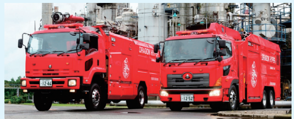
ドラゴンハイパー・コマンドユニットの中核車両である大型放水砲搭載ホース延長車（左）と大容量送水ポンプ車（右）
